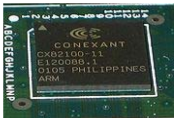
یک پردازنده Conexant ARM که عمدتاً در روترها بکار میرود
